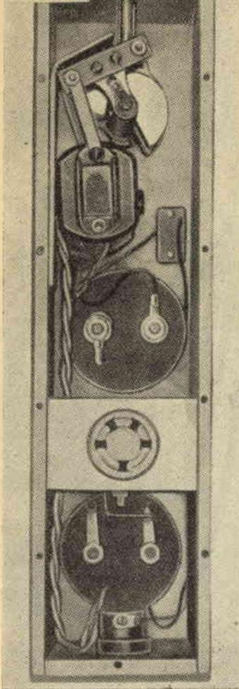
Foto B - Veduta posteriore dello strumento montato. Notate il ponticello di alluminio che sorregge lo zoccolo a 5 terminali. Il coperchio è fatto di plastica trasparente
