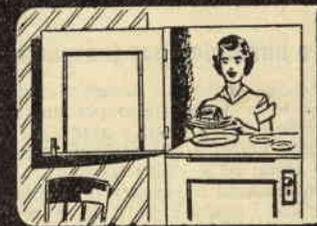
**L**A SEZIONE SUPERIORE va trattata in maniera simile, lasciando la sezione inferiore aperta e bloccata dai cunei, in modo che serva da appoggio per tenere a posto l'altra. Lo spinotto della cerniera superiore va sistemato al suo posto prima di tracciare e tagliare l'incasso per la foglia della cerniera inferiore, che va poi assicurata come l'altra a mezzo di viti.
