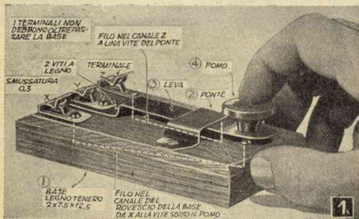
Il tasto per telegrafo della nostra fotografia, fig. 1, come in definitiva qualsiasi tasto telegrafico, altro non è che un interruttore e, lentezza di trasmissione a parte, anche un pulsante potrebbe essere impiegato al suo posto. Per trasmettere dei messaggi, però, vi occorrerà qualcosa del genere da noi descritto, che tornerà utilissimo a
