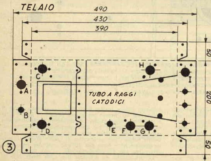
A = CAMBIA TENSIONE; B = ALIMENTAZIONE; C = V1; D = V2;
