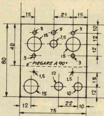
**6** PIANTA DEL TELAIO (ALLUMINIO, OTTONE, ACCIAIO)
