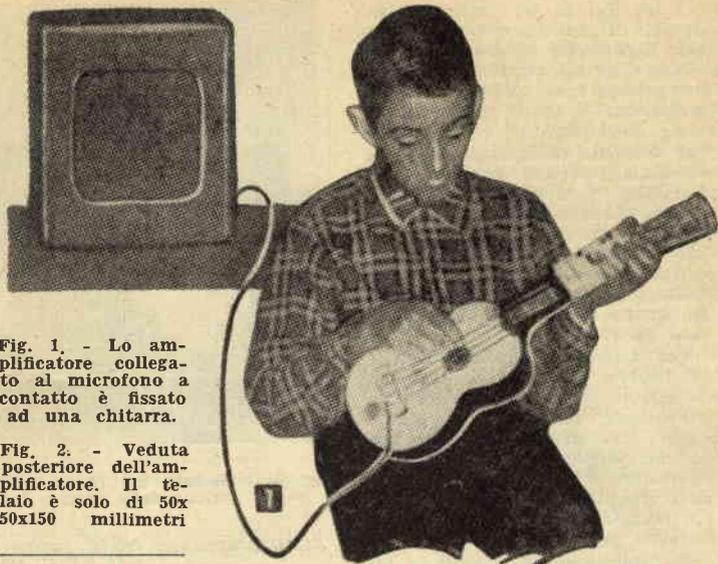
**Fig. 1.** - Lo amplificatore collegato al microfono a contatto è fissato ad una chitarra.
